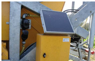
Panneau solaire alimentant la régulation électronique Chambre agriculture 85
